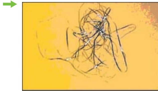
Vidrio metálico (FeCoSiB) obtenido en forma de cinta
