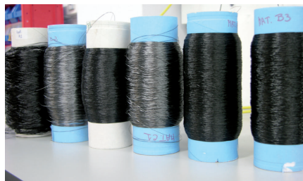
Figura 3. Bobinas de monofilamento de polipropileno con nanotubos de carbono.
