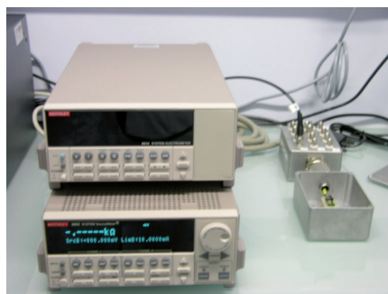
Figura 4. Equipo utilizado para medir la conductividad e imagen de la muestra para la aplicación del método de dos puntas.
