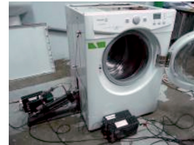
Figura 5. Implementación del prototipo de amortiguador MR en una lavadora.
