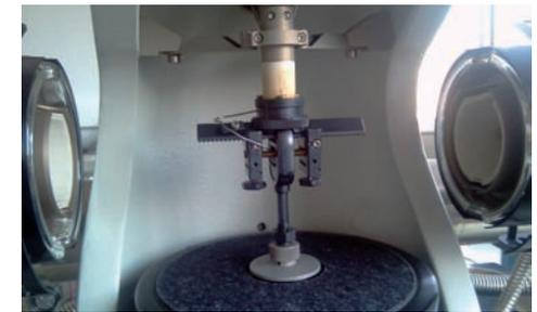
Equipo de ensayos térmicos dinámico mecánico.
