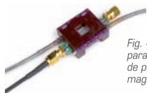
Fig. 4. Sensor GMI para detección de partículas magnéticas.
