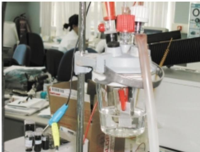
*Preparación de un film electroactivo por electropolimerización (EAP) para su empleo en Fotovoltaicos, CIDETEC*
