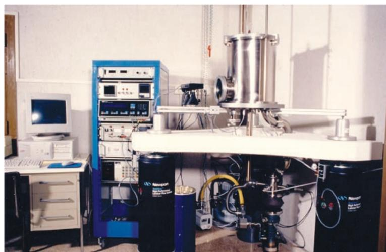
Péndulo de baja frecuencia y oscilación forzada para espectrometría mecánica entre 80 K y 1.250 K. Grupo de Investigación en Metalurgia Física UPV/EHU (Fabricación propia)
