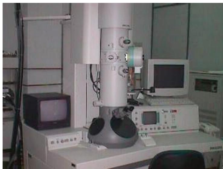
Microscopio electrónico de transmisión de 200Kv Philips CM 200 equipado con microanálisis EAX. Grupo de Investigación en Metalurgia Física UPV/EHU
