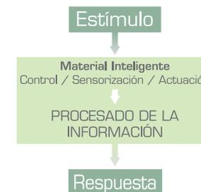
Figura 1: Principio de funcionamiento de los materiales inteligentes
