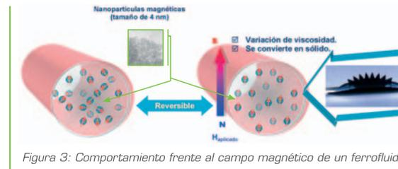
Figura 3: Comportamiento frente al campo magnético de un ferrofluido
