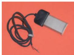
Sensor piezoeléctrico polimérico
