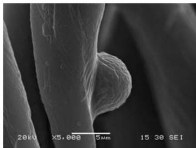
Figura 2: Partícula de plata recubierta por el polímero adherida al hilo.
