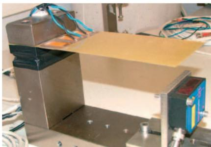
Figura 1. Demostrador de viga en voladizo en la que se han ensayado los elementos piezoeléctricos.
