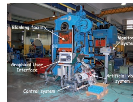
Figura 10: Demostrador final aplicado a una instalación industrial de corte en troquel progresivo.
