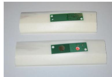
Muestras después de ensayo de ciclado térmico.
