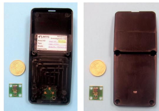
Carcasa inyectada en PA6-M30 con sensor sobreinyectado (izqda, cara no vista; dcha cara vista).
