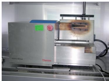
Figura 1. Miniextrusora utilizada para obtener hilos conductores.
