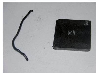
Figura 2. Aspecto de los *compounds* conductores obtenidos tras el procesado por extrusión y por inyección.
