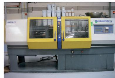
Figura 2. Inyectora utilizada para obtener probetas conductoras.
